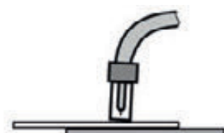
Горелка с обычным соплом, установленная под углом
