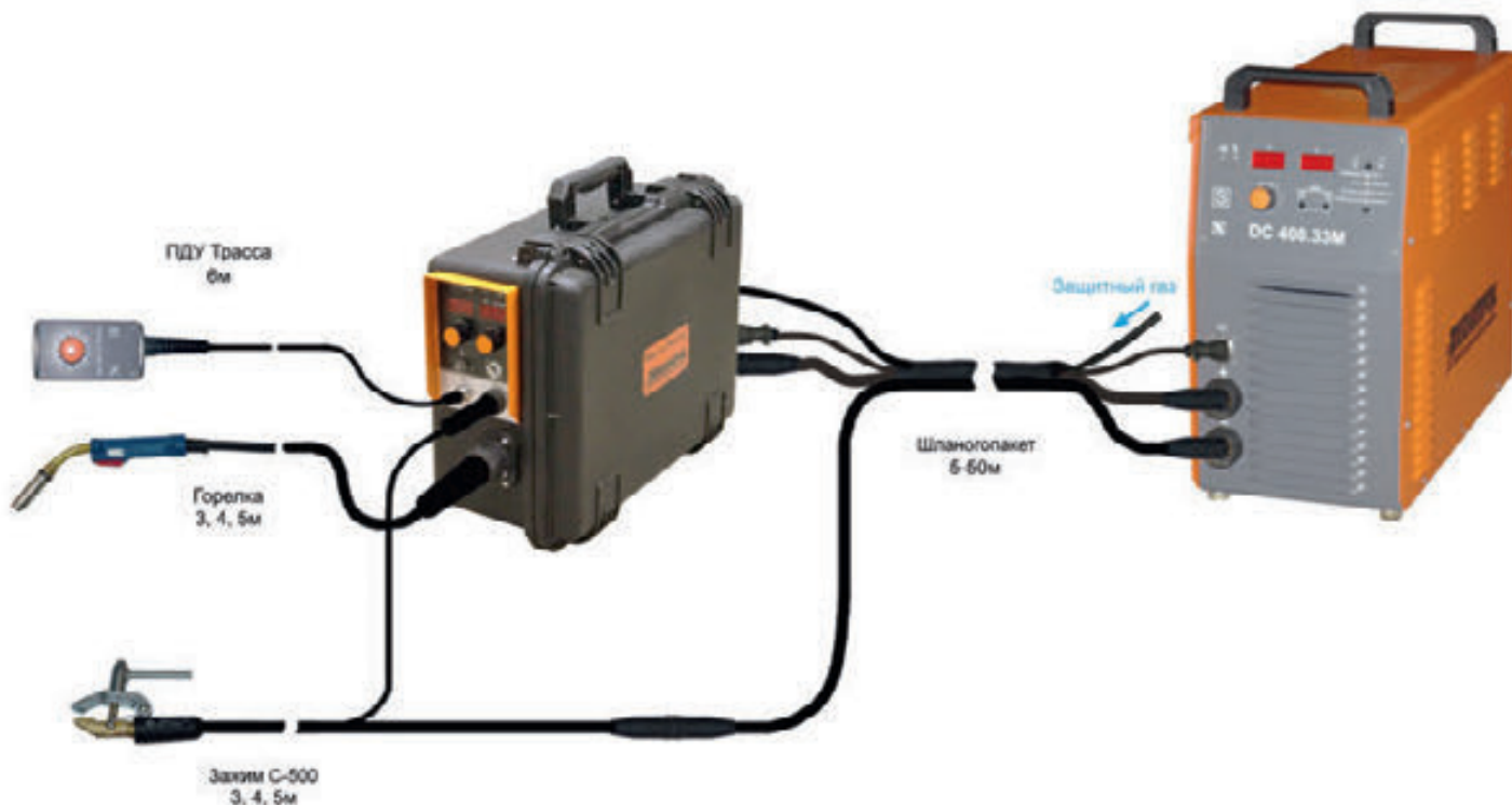
Схема сборки при сварке в режиме MIG/MAG с полуавтоматом ПМ4.33 «Трасса»
