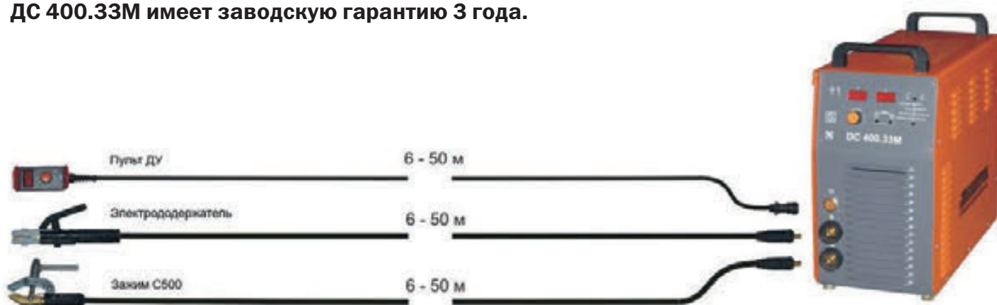
Схема сборки при сварке в режиме ММА
