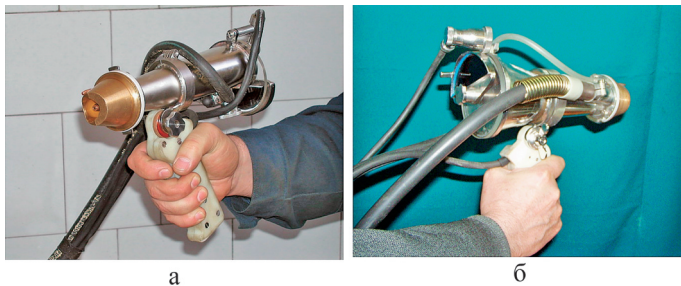
Рис. 3. Горелка для сварки плавящимся электродом в гибком мини-кессоне:
