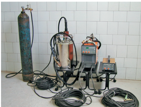
Рис. 2. Полуавтомат для механизированной сварки под водой
