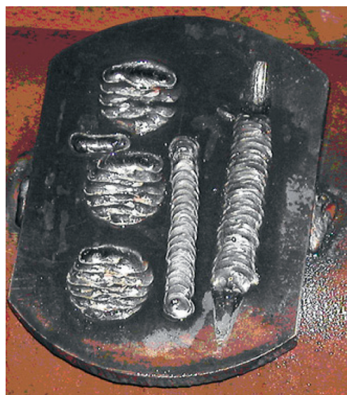
Рис. 6. Натурный образец наплавочных швов, выполненных установкой УПСС-1
