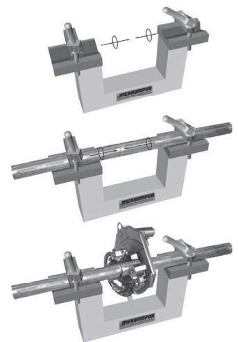
Рис. 6. Схема сборки труб под сварку без прихваток
