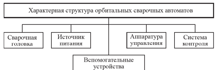
Рис. 1. Характерная структура орбитальных сварочных автоматов
