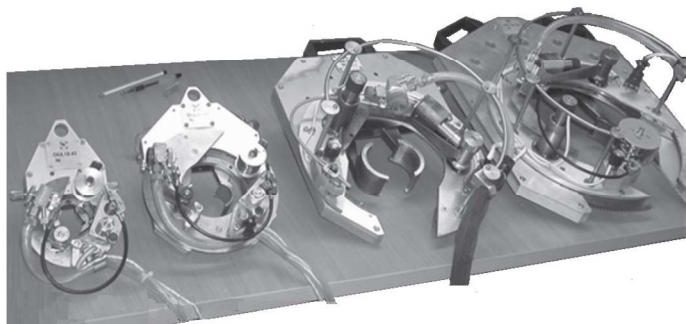
Рис. 2. Гамма сварочных головок ОКА
