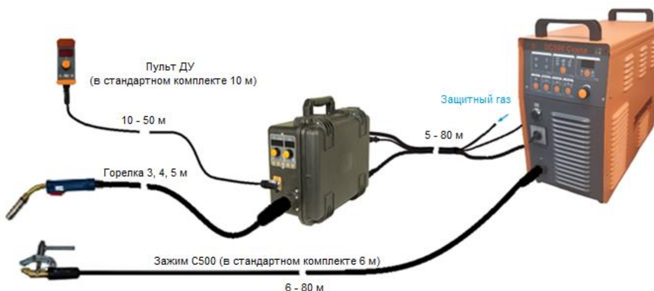
Рисунок 14 – Схема подключения при механизированной сварке
