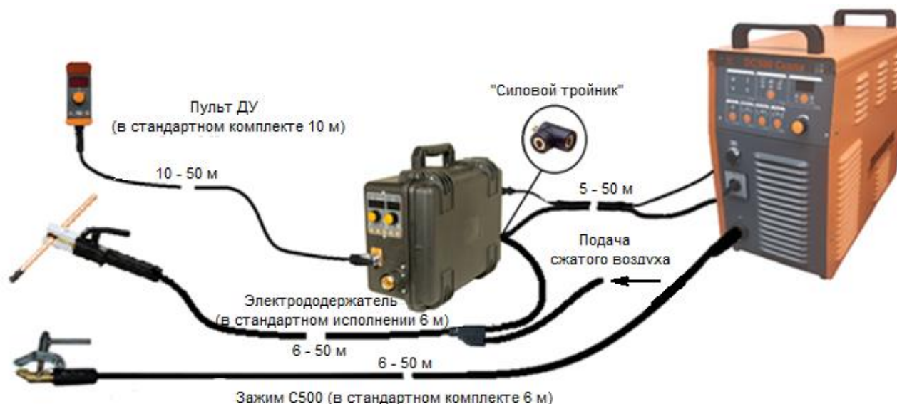
Рисунок 11 - Схема подключения в режиме ВДС
