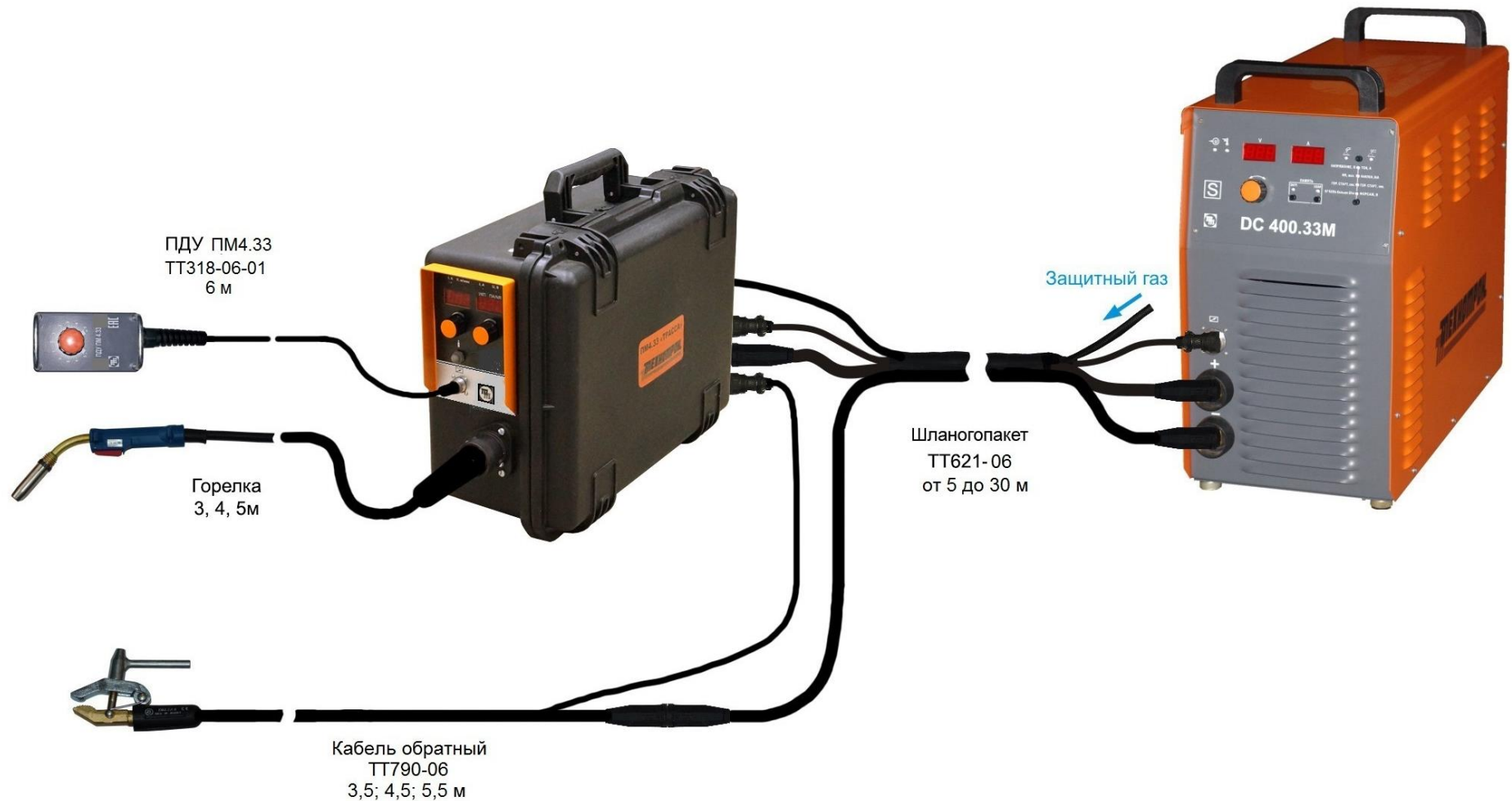
Рисунок В.1 – Схема подключения при сварке газозащитной проволокой
