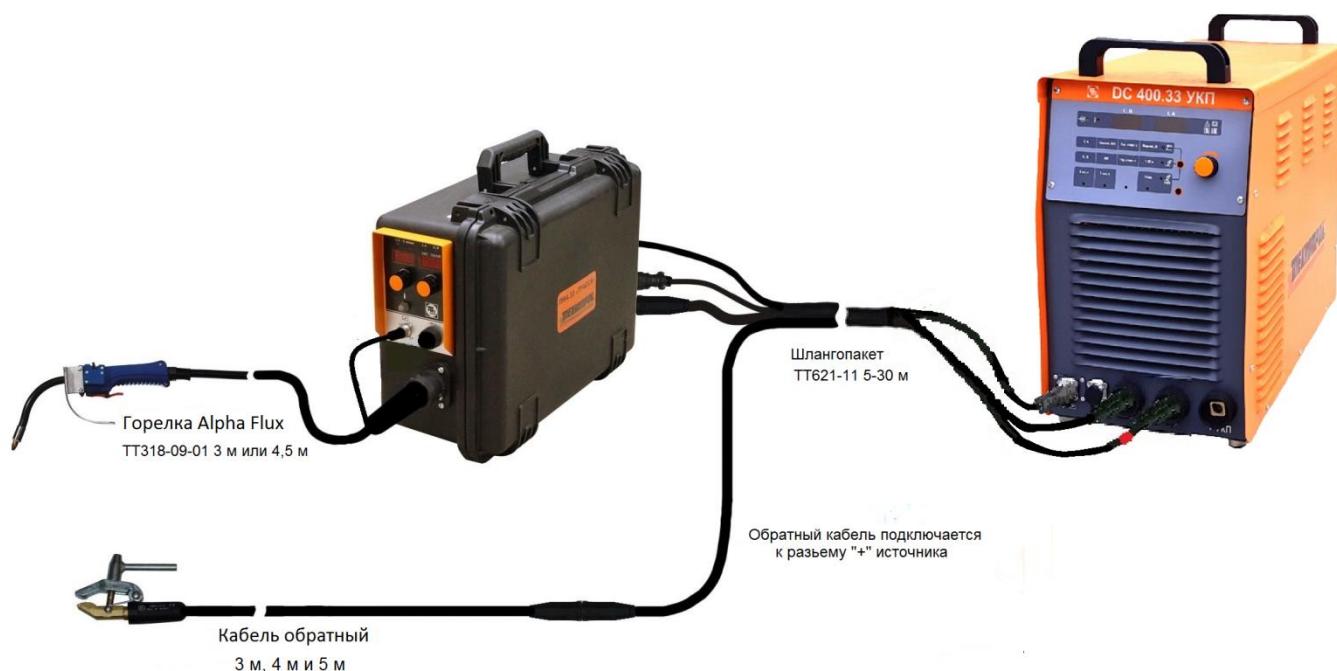
Рисунок 11 – Схема подключения при сварке газозащитной и самозащитной проволокой
