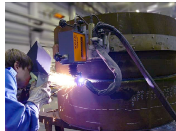
Выборка дефектного шва на трубе Ø1420мм
