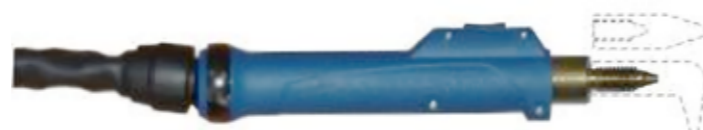
Инструмент-электрод контактной сварки с ручным управлением включения импульса
