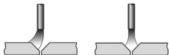
Ручная дуговая сварка намагниченной трубы обычным сварочным источником
