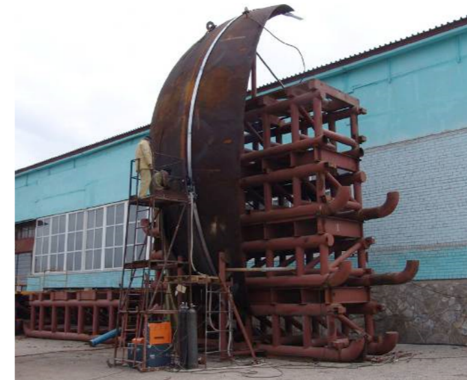
УАСТ-1 на сварке шаровых резервуаров
