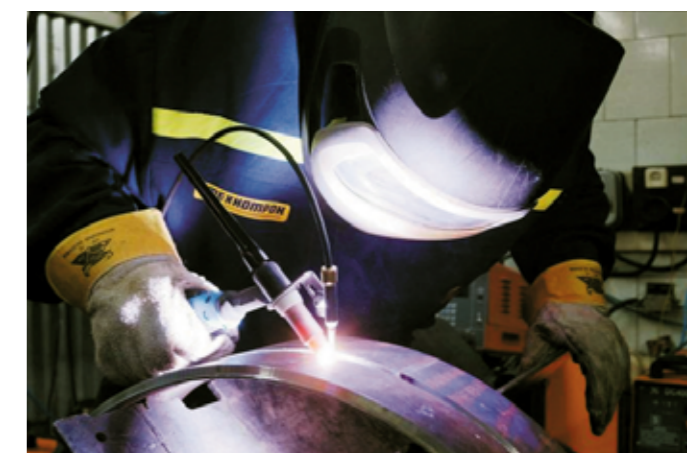
Сварка корневого прохода трубы 530x10
