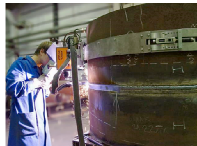
Возможна автоматическая строжка в любом пространственном положении
