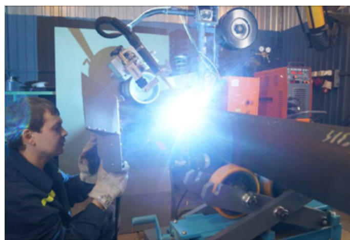
Сварка трубы 325x16 в импульсном режиме
