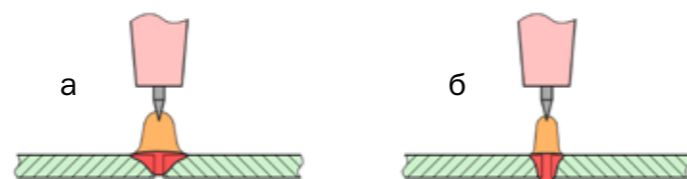
а) «обычная» сварочная дуга б) «фокусированная» сварочная дуга
