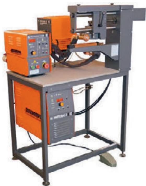
Свариваемое изделие устанавливается в специальную оснастку(оправку) или непосредственно на продольную подложку установки. При помощи специального рычага сварочный ролик опускается, прижимая детали с усилием, заданным преднатяжением пружины. После нажатия кнопки «Пуск» производится цикл сварки с заданными параметрами сварочных импульсов, скоростью и шагом сварки.
