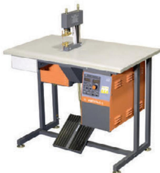
Свариваемое изделие располагают на нижнем электроде и нажимают педаль установки. При этом верхний электрод, перемещаясь вниз, сжимает свариваемые детали. При достижении заданного давления на электродах от сварочной головки в источник питания поступает сигнал запуска. Источник питания вырабатывает импульс сварочного тока заданной длительности и амплитуды, которые поступают на электроды сварочной головки.
