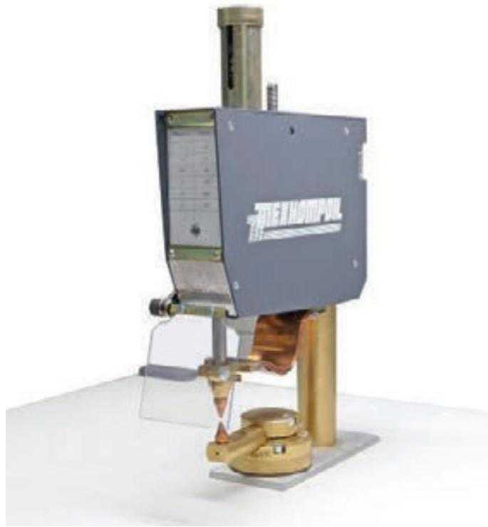
При достижении заданного давления на электродах, от сварочной головки в источник питания поступает сигнал запуска. Источник питания вырабатывает импульс сварочного тока заданной длительности и амплитуды, которые поступают на электроды сварочной головки.
