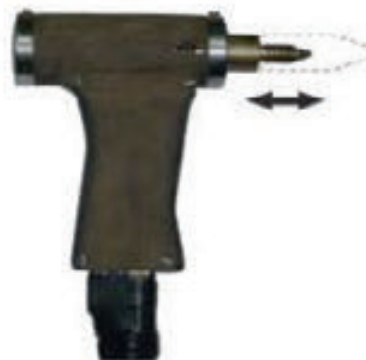
Пистолет контактной сварки с регулируемым усилием нажатия, рабочим ходом до 10 мм и автоматическим включением импульса
