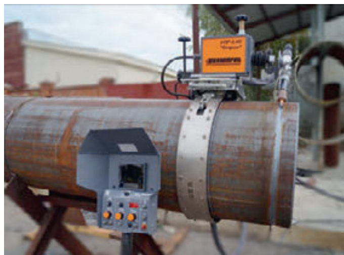
Автоматическая головка УПР-2.4С «Стриж» с пультом управления на трубе Ø530мм
