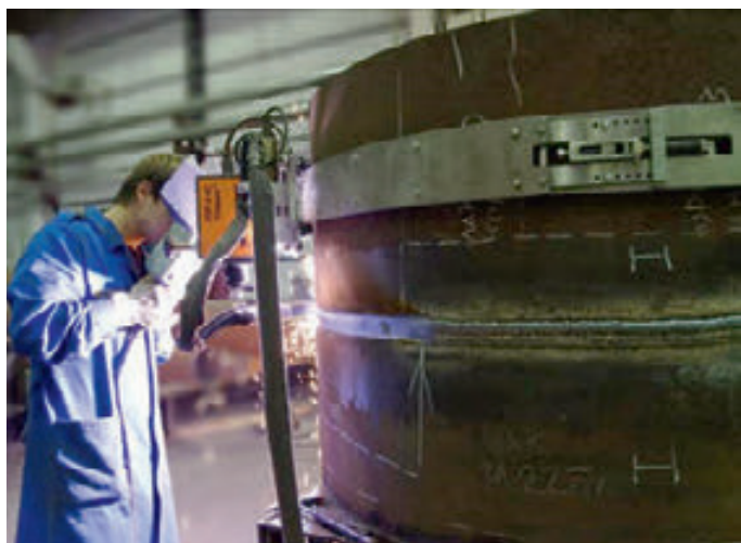
Возможна автоматическая строжка в любом пространственном положении
