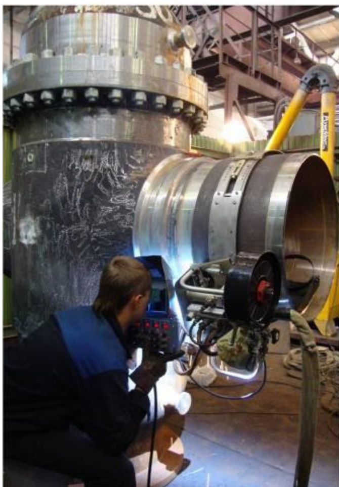
УАСТ-1 Сварка шиберных задвижек d=500 - 1200 мм с катушками
