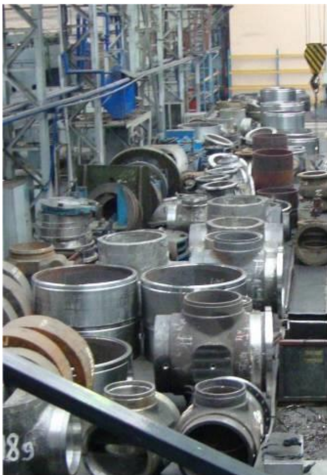
УАСТ-1 Сварка шиберных задвижек d=500 - 1200 мм с катушками
