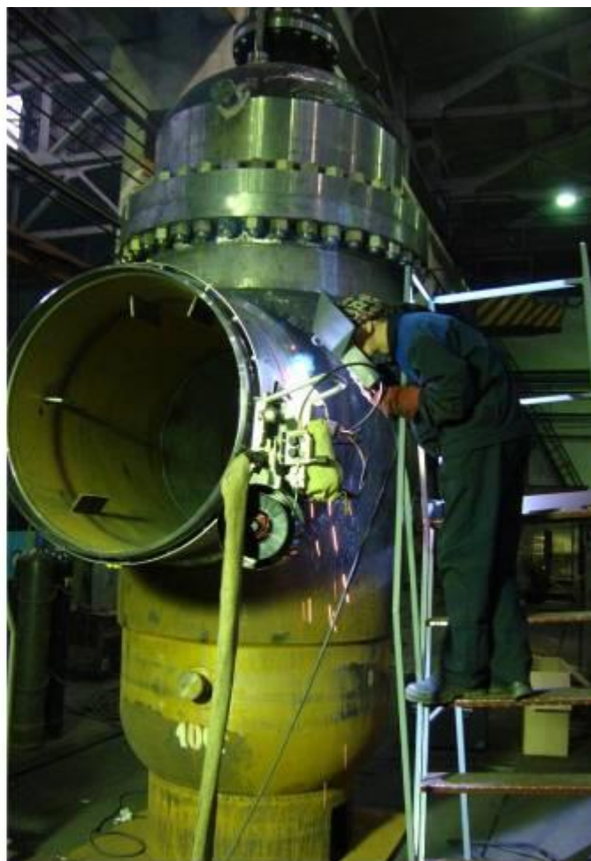
УАСТ-1 Сварка шиберных задвижек d=500 - 1200 мм с катушками
