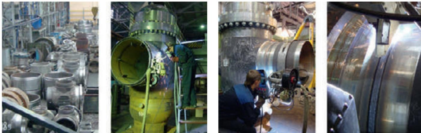
Сварка шибрных задвижек d500-1200 мм с катушками
