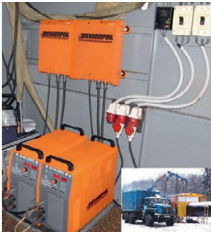
Комплект оборудования в кунге автомобиля (2 источника, 2 блока управления)
