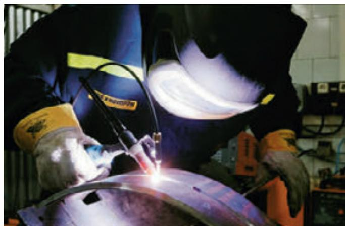
Сварка корневого прохода трубы 530x10
