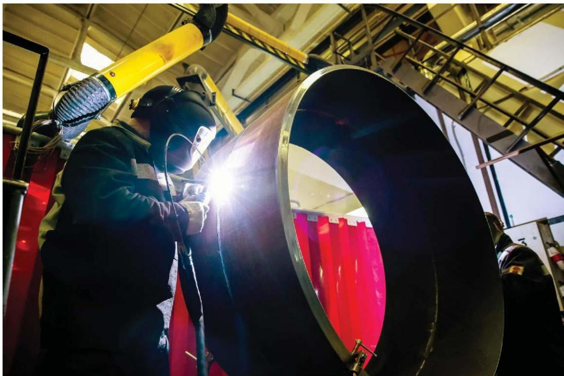
Впервые в ПАО «Газпром» испытывается технология сварки труб большого диаметра класса прочности K65. Аттестация новой технологии доверена предприятию «Газпром трансгаз Чайковский» и ведётся на базе цеха подготовки производства Инженерно-технического центра Общества.
