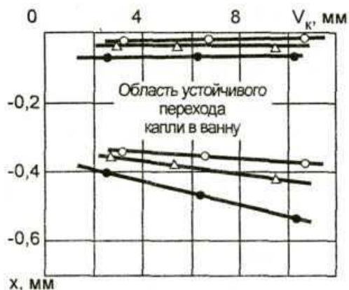
Рис. 1. Зависимость заглубления капли в ванну, обеспечивающего ее устойчивый переход при сварке с короткими замыканиями, от объема капли ( \circ - отсутствие тока сварки в начале короткого замыкания; \blacktriangle , \circ\blacktriangle - при неблагоприятном действии тока в момент касания, соответственно 150 и 200 А; d_3 = 1,6 мм)
